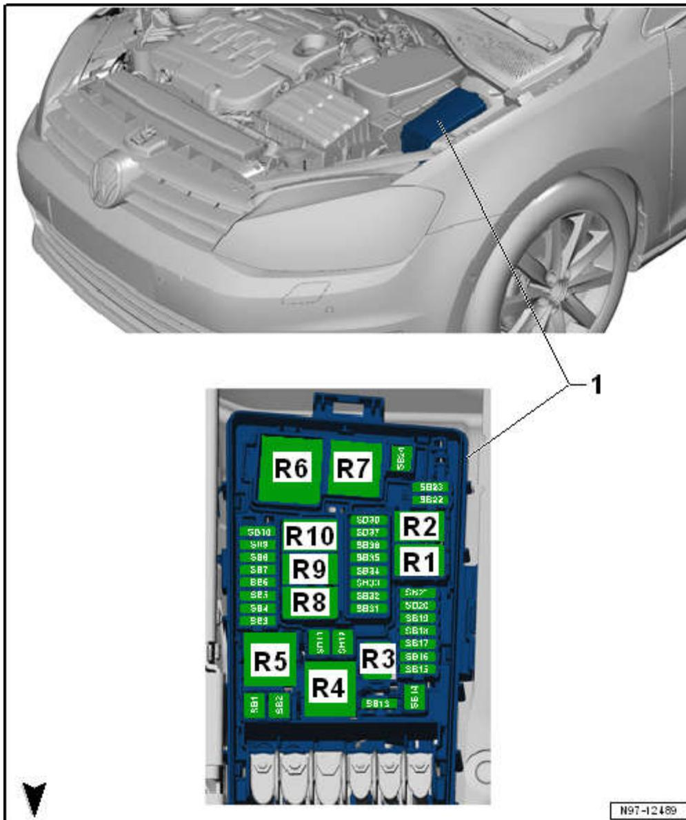
1 - 继电器和保险丝座1 -SR1- , 在发动机舱电控箱上
